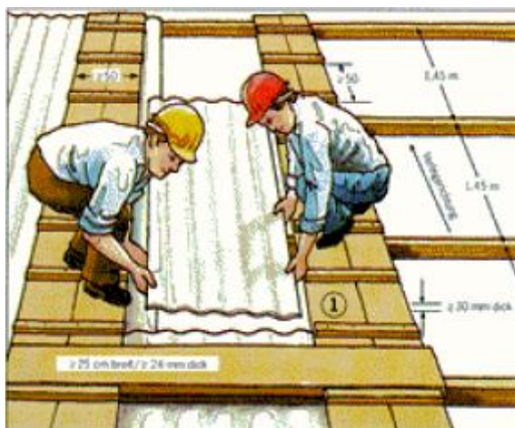
Slika 5: Kako je treba izdelati prehode za gibanje po strešnih kritinah, ki nimajo visoke nosilnosti. (18)
